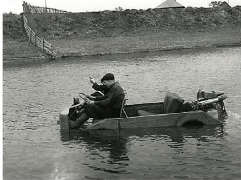
Испытание открытого варианта на плавучесть. 1955 г. ГА в г.Ирбите
